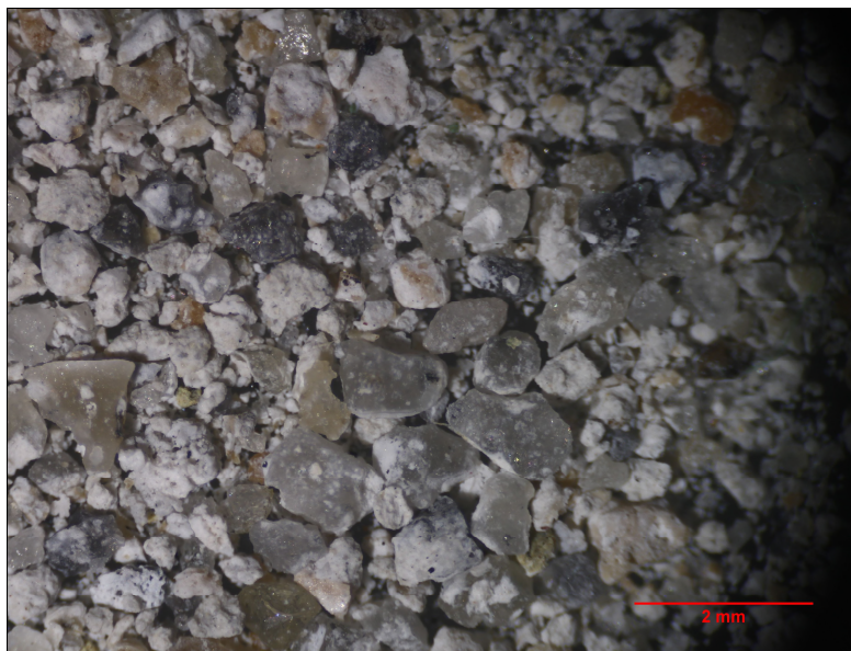
Obr. 13: Mikrofotografie promytého kameniva
